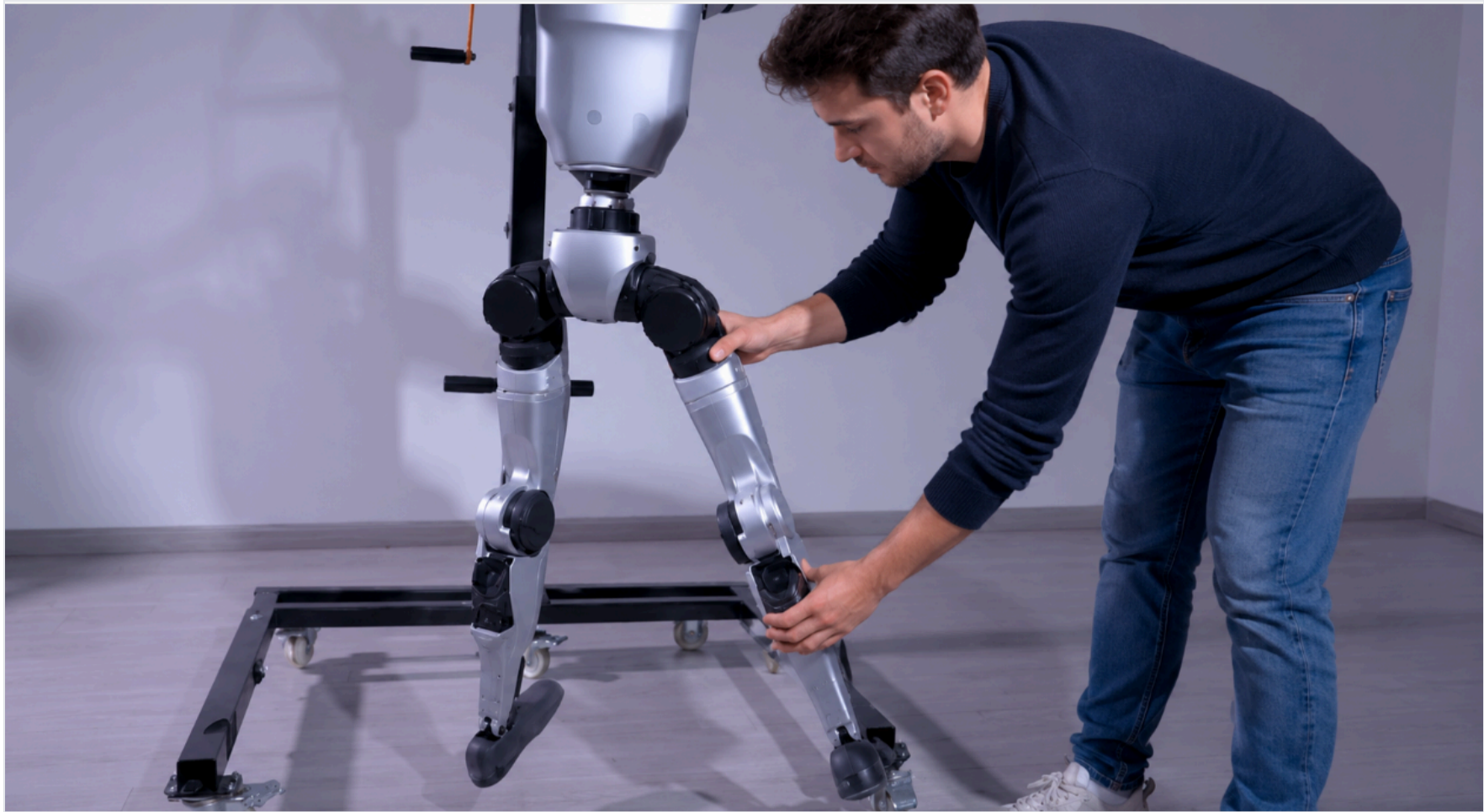
ABB. B Standard-Aufbau für Sim-to-Real-Tests: G1 in Hebevorrichtung mit angeflanschem Gewicht-Set. Das Tethering ist zwingend, solange neue Policies noch nicht in mehreren Sim-to-Sim-Iterationen validiert sind (Kapitel 8, 14).
