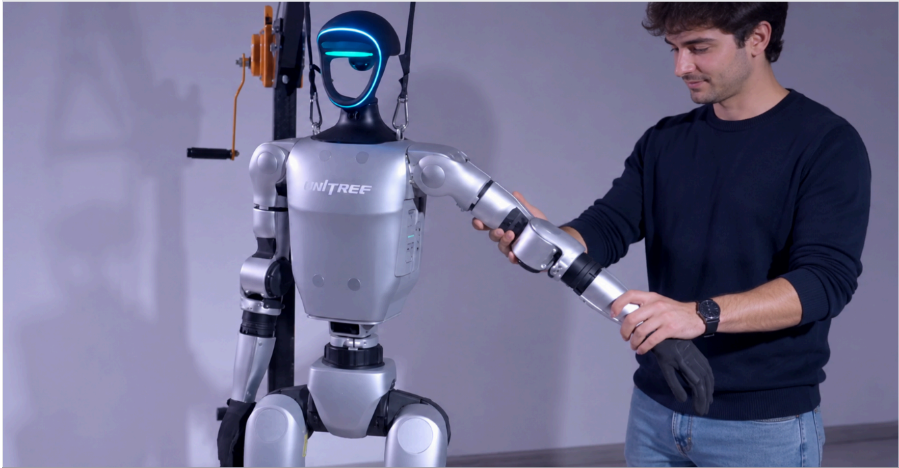
ABB. A Realer Unitree G1 im wetando-Trainingssetup. Skill-Aufzeichnung am physischen Roboter ist eine zentrale Datenquelle, die Sim-to-Real-Pipelines ergänzt — wir kommen in Kapitel 12 ausführlich darauf zurück.
