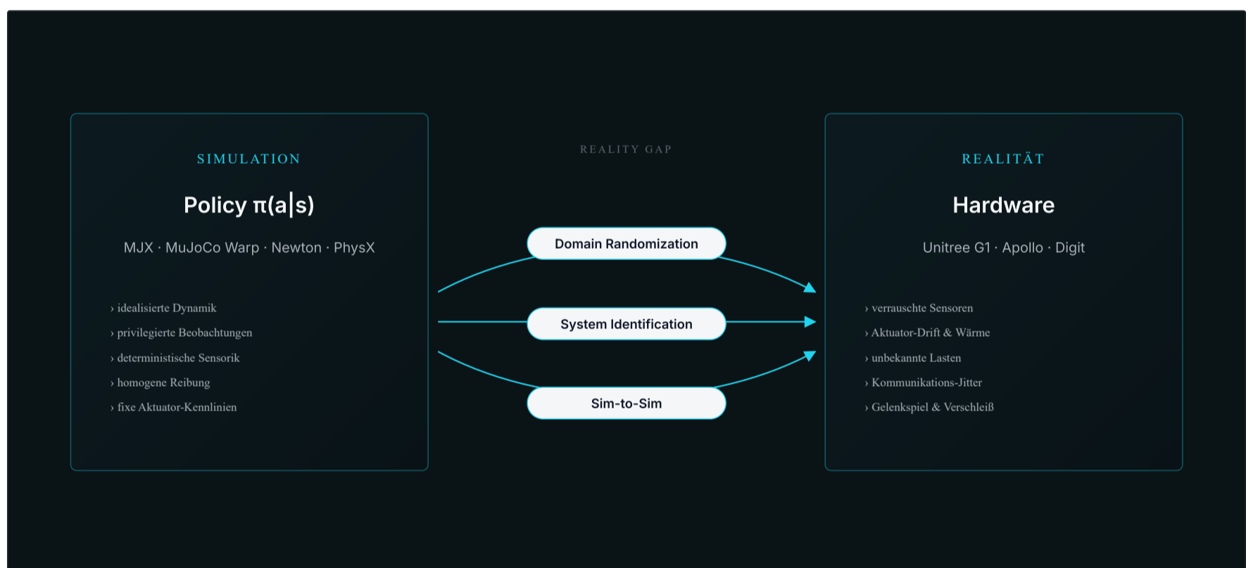
ABB. 1 Die Reality Gap und die drei wichtigsten Brücken — Domain Randomization, System Identification und Sim-to-Sim.
